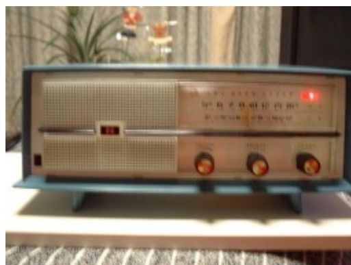
昭和36年（1961年）頃製造 Mt管トランスレス 5球スーパーヘテロダイン方式
