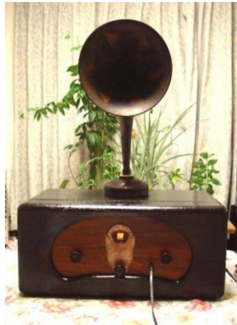
昭和5年頃（1930年）頃製造、 ナス管使用高周波増幅再生検波5球ラジオ
