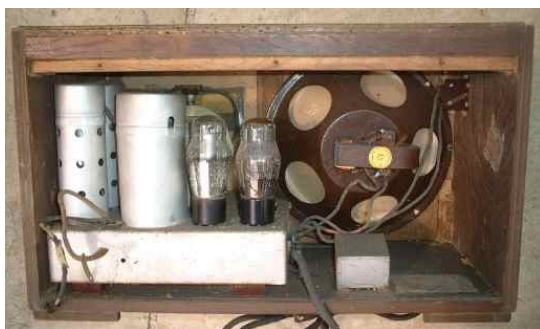
松下無線（NATIONAL） 「放送局型第123号受信機」 昭和16～18年頃 トランスレス用ST管用。 AM、1バンド
